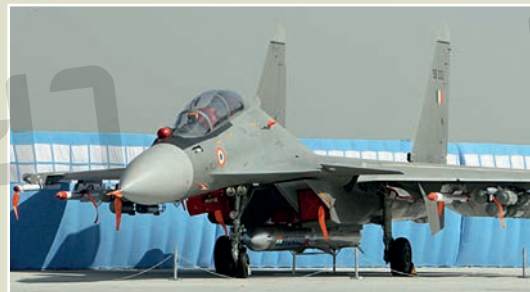
เครื่องบินขับไล่โจมตีพิสัยไกล ซู-๓๐ เอ็มเคไอ ติดตั้งขีปนาวุธรุ่นใหม่บราฮ์โมส (Brahmos) น้ำหนัก ๒,๕๐๐ กิโลกรัม หัวรบหนัก ๓๐๐ กิโลกรัม ความเร็ว ๒.๘ มัค และระยะยิงไกล ๔๐๐ กิโลเมตร (ร่อนยิงจากเครื่องบิน) เป็นแบบจรวดร่อน เครื่องบินซู-๓๐ เอ็มเคไอ ประจำการรวม ๒๗๒ เครื่อง
