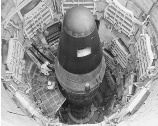
ขีปนาวุธข้ามทวีป (ICBM) แบบมินิแมน (LGM-30 Minuteman-III) กองทัพอากาศสหรัฐอเมริกา ระยะยิงไกล ๑๓,๐๐๐ กิโลเมตร และติดตั้งอยู่ใต้พื้นดิน (Silo) ประจำการ ๓ กองบิน ขีปนาวุธ ใช้หัวรบนิวเคลียร์แบบดับเบิ้ลยู ๘๗ (W87)
