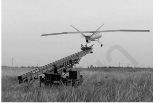
อากาศยานไร้คนขับ (UAV) แบบเฮร์เมส ๔๕๐ (Hermes 450) ทำการบินโดยใช้อุปกรณ์ในการนำส่งขึ้นสู่อากาศเพื่อปฏิบัติการลาดตระเวนหาข่าวในพื้นที่เป้าหมาย
