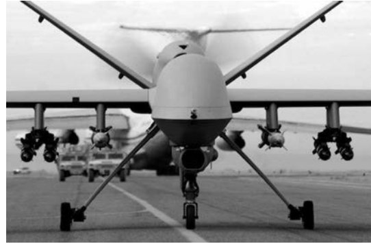
อากาศยานไร้คนขับ (UAV) แบบเอ็มคิว-๙ (MQ-9 Reaper) ติดตั้งจรวดนำวิถีโจมตีภาคพื้นดิน ขณะทำการวิ่งขึ้นจากสนามบินประเทศอัฟกานิสถาน ปี พ.ศ. ๒๕๕๐ น้ำหนักบินขึ้นสูงสุด ๔,๗๖๐ กิโลกรัม ความเร็วสูงสุด ๔๘๒ กิโลเมตรต่อชั่วโมง บินได้นาน ๑๔ ชั่วโมง และติดตั้งอาวุธรวม ๗ จุด (AGM-114 Hellfire จำนวน ๔ ลูก)
