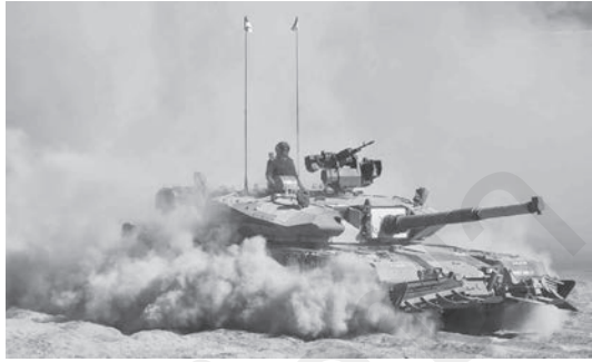
รถถังหลักแบบอาร์จัน (Arjun Mk-II) ทำการฝึกในทะเลทราย (วันที่ ๒๓ กันยายน พ.ศ. ๒๕๖๓) ปืนใหญ่รถถังชนิดมีเกลียว ขนาด ๑๒๐ มิลลิเมตร เครื่องยนต์ ดีเซล (MTU MB 838 Ka-501) ขนาด ๑,๔๐๐ แรงม้า ประสิทธิภาพ ๑๒๔ คัน
