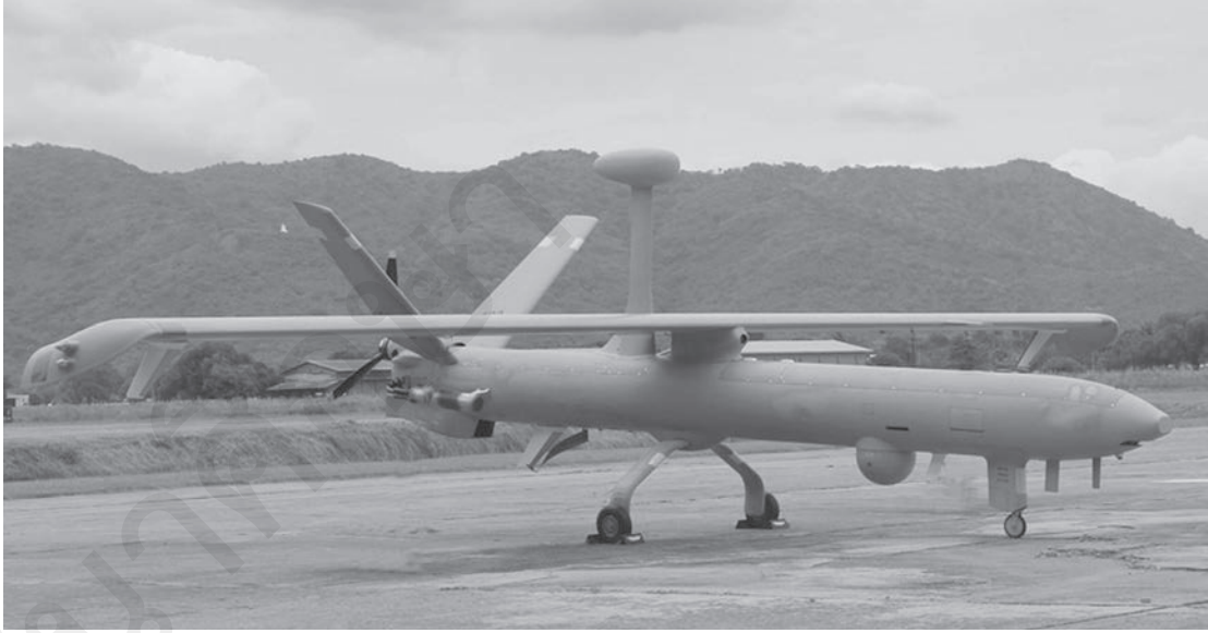
อากาศยานไร้คนขับ (UAV) แบบเฮร์เมส ๔๕๐ (Hermes 450) กองทัพบกไทย น้ำหนัก ๔๕๐ กิโลกรัม ยาว ๖.๑ เมตร ช่วงปีก ๑๐.๕ เมตร เครื่องยนต์ ขนาด ๕๒ แรงม้า ความเร็วสูงสุด ๑๗๖ กิโลเมตร และบินได้นาน ๒๐ ชั่วโมง กลุ่มอาเซียนประจำการ ประกอบด้วย สิงคโปร์ ฟิลิปปินส์ และไทย (แบบเฮร์เมส ๔๕๐ อากาศยานไร้คนขับขนาดกลาง ภารกิจลาดตระเวนหาข่าว)
