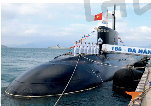
เรือดำน้ำดีเซลไฟฟ้าดานัง (186 : DA NANG) กองทัพเรือเวียดนามชั้นกิโล (Kilo) ขนาด ๑,๗๑๑ ตัน ดำน้ำได้ลึกกว่า ๓๐๐ เมตร ตอร์ปิโด (ขนาด ๕๓๓ มิลลิเมตร ชนิดหกท่อยิง พร้อมลูกตอร์ปิโด ๑๘ ลูก แบบไทป์-๕๓ และติดตั้งจรวดร่อน 3M-45)
