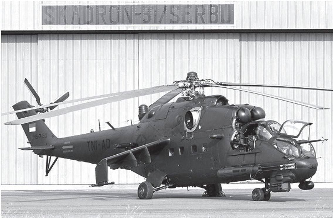
เฮลิคอปเตอร์โจมตีแบบเอ็มไอ-24 (Mi-24) น้ำหนักบินขึ้น 12,000 กิโลกรัม เจ้าหน้าที่ประจำเครื่อง 3 นาย บรรทุกทหาร 8 นาย ติดตั้งอาวุธได้ 6 จุด (น้ำหนักรวม 1,500 กิโลกรัม) ภารกิจต่อสู้รถถัง ติดตั้งจรวดนำวิถีแบบเอที-6เอ (AT-6A Spiral) ระยะยิง 400-5,000 เมตร (ในภาพแบบเอ็มไอ-35มี กองทัพบกอินโดนีเซียรวม 7 ลำ)
