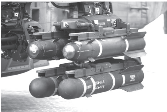
จรวดนำวิถีต่อสู้รถถังแบบเฮลไฟร์ (AGM-114/A/F/K Hellfire) เครื่องละ 16 ท่อยิง (ด้านละ 8 ท่อยิง) น้ำหนัก 45 กิโลกรัม หัวรบดินระเบิดแรงสูงหนัก 8 กิโลกรัม นำวิถีด้วยแสงเลเซอร์ และระยะยิง 8,000 เมตร
