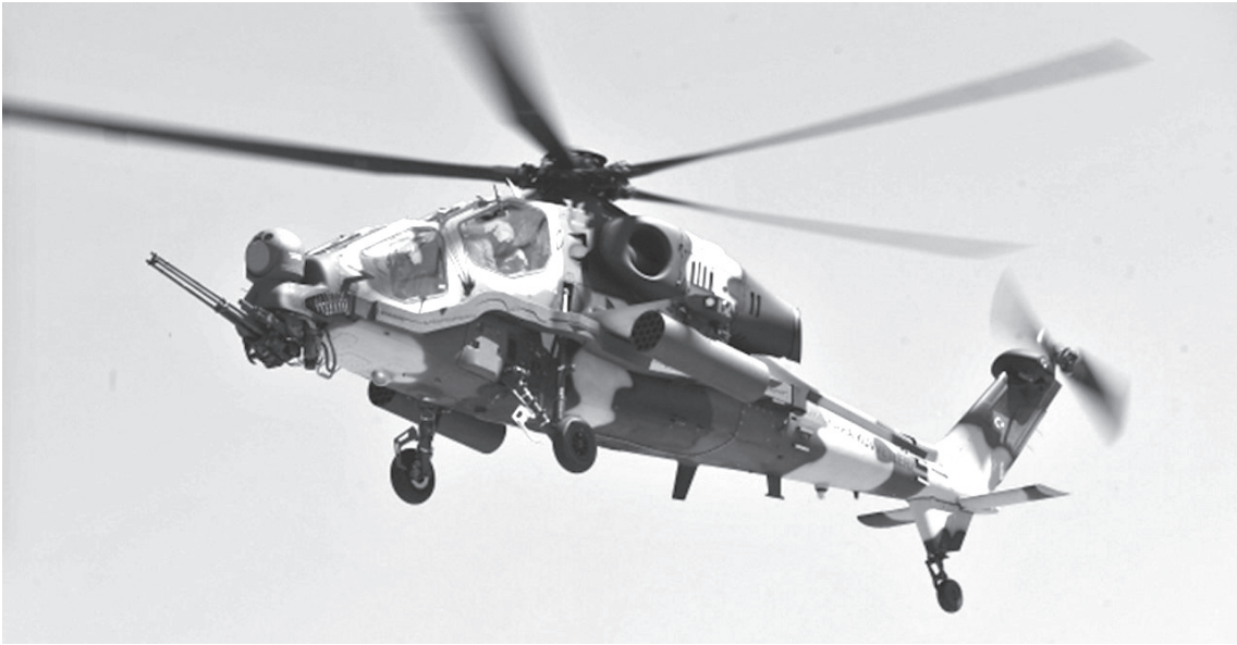
เฮลิคอปเตอร์โจมตีแบบที-129บี (T-129B) นักบิน 2 นาย ปีนกลขนาด 20 มิลลิเมตร (กระสุน 500 นัด) จรวดนำวิถีต่อสู้รถถังเฮลิไฟร์ (และจรวดนำวิถีต่อสู้รถถังขนาดหนักแบบอัมบัส ระยะยิง 8,000 เมตร) ประจำการกองทัพบกตุรกี และฟิลิปปินส์ (รอการรับมอบประจำการชุดแรก พ.ศ.2565)
