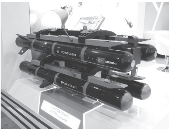
จรวดนำวิถีต่อสู้รถถังขนาดหนักอัมบัส (UMTAS) พัฒนามาจากประเทศตุรกี น้ำหนัก 37.5 กิโลกรัม ยาว 175 เซนติเมตร เส้นผ่าศูนย์กลางกลางจรวด 16 เซนติเมตร ขับเคลื่อนด้วยเชื้อเพลิงแข็ง นำวิถี ด้วยแสงเลเซอร์ และระยะยิง 500-8,000 เมตร ติดตั้งกับเฮลิคอปเตอร์โจมตีแบบที-129บี (T-129B)
