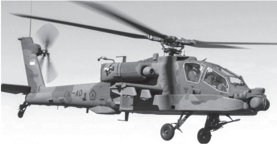
เฮลิคอปเตอร์โจมตีเอช-64อี (AH-64E Guardian) ยาว 17.73 เมตร สูง 3.87 เมตร ใบพัดชนิดสี่ก้าน (เส้นผ่าศูนย์กลาง 14.63 เมตร) ปีกกลอากาศขนาด 30 มิลลิเมตร(กระสุน 1,200 นัด) ติดตั้งอาวุธ 4 จุด (ในภาพกองทัพบกอินโดนีเซีย รุ่นเอช-64อี สังกัดฝูงบินที่ 11 ฐานทัพอากาศเซมารัน จังหวัดชวากลาง)
