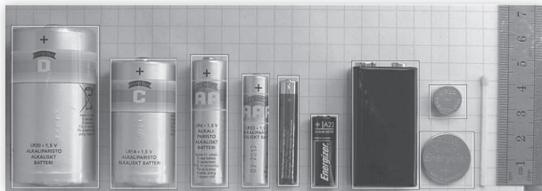
รูป การเปรียบเทียบขนาดของแบตเตอรี่ที่มีขายทั่วไปตามท้องตลาด (จากซ้ายไปขวา D (LR20), C (R14), AA (LR6), AAA (LR03), AAAA (LR8D425), A23 (8LR932), 9-Volt (6LR61), CR2032 และ LR44)
