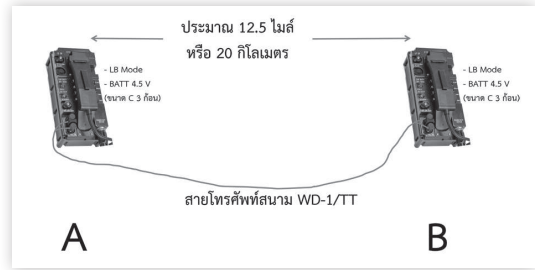
รูป การต่อใช้งานเครื่องโทรศัพท์ ETP-1 เมื่อเลือก การทำงานแบบ LB
