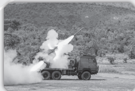
รูปที่ 3 : ระบบจรวดหลายลำกล้อง ขนาด 122 มม.(DTI-2)
