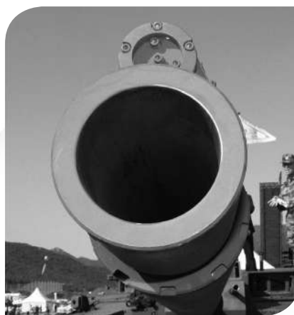
ปืนหลักของรถถังแบบเค-2 (K-2 Black Panther) ปืนลำกล้องเรียบ ขนาด 120/55 มิลลิเมตร(CN08) น้ำหนัก 1,324 กิโลกรัม ยาว 6.6 เมตร ระยะยิงหวังผล 3,000 เมตร (APFSDS-T) ปืนใหญ่รถถังเป็นเทคโนโลยีจากประเทศเยอรมัน
