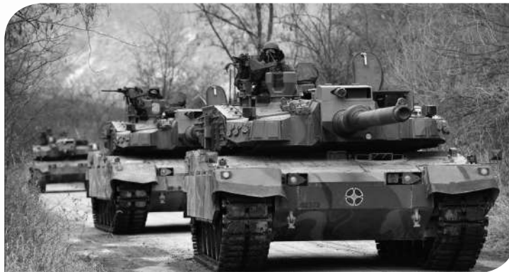
รถถังหลักแบบเค-2 (K-2 Black Panther) ขนาด 55.0 ตัน ยาว 7.8 เมตร กว้าง 3.6 เมตร สูง 2.4 เมตร เครื่องยนต์ดีเซล (MTU MT-883 Ka-501) ขนาด 1500 แรงม้า ความเร็วในภูมิประเทศ 50 กิโลเมตรต่อชั่วโมง ระยะปฏิบัติการ 450 กิโลเมตร และพลประจำรถ 3 นาย
