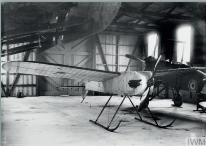
รูปที่ 1 Aerial Target เครื่องบินบังคับวิทยุของอังกฤษจากสงครามโลกครั้งที่หนึ่ง นับเป็นโมโนเพลนที่ควบคุมด้วยคลื่นวิทยุเครื่องแรก ปัจจุบันเป็นส่วนหนึ่งของคอลเล็กชันของ Imperial War Museums หรือ IWM (ที่มา: https://www.iwm.org.uk/collections/item/object/205315299 )
