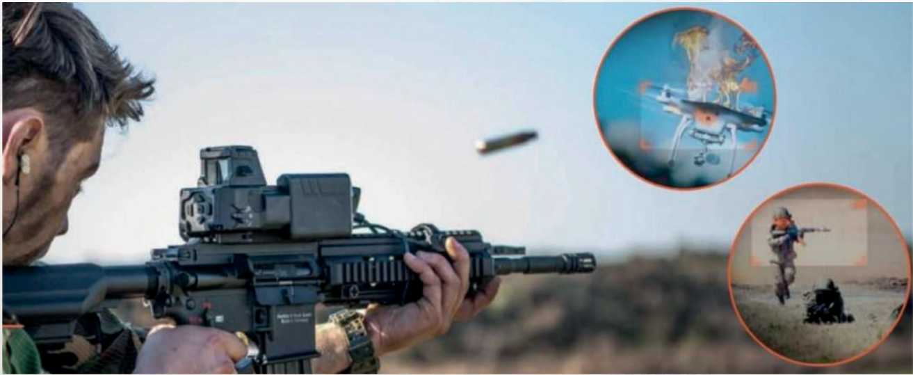
รูปที่ 7 Smart Shooter จาก บริษัท อิสราเอล SMASH 2000 Plus SMASH ระบบใช้เทคโนโลยีการตรวจจับการมองเห็นและติดตามและเป้าหมาย เพื่อเพิ่มความแม่นยำในการเล็งและลดเวลาในการยิง
