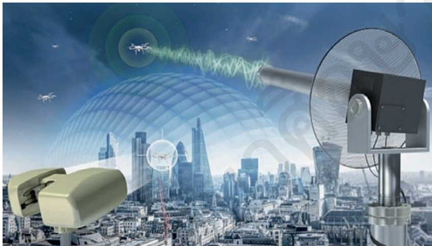
ระบบต่อต้านอากาศยานไร้คนขับ Falcon Shield Selex EX ซึ่งมีจุดเด่นที่การ “เอาชนะ” โดยใช้คลื่นสัญญาณรบกวนในหลายระดับ ตั้งแต่การบีบบังคับให้ผู้ควบคุมอากาศยานไร้คนขับที่เป็นเป้าหมายต้องบังคับเครื่องลงถึงระดับการทำให้เครื่องตก
