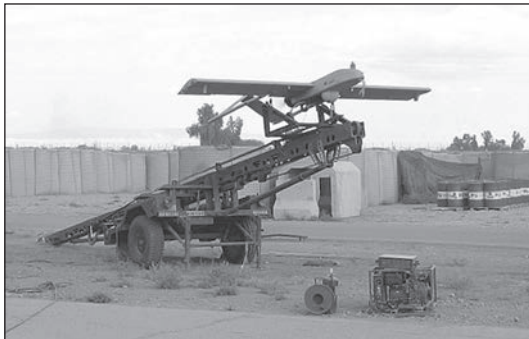
อากาศยานไร้คนขับแบบอาร์คิว-๗ (RQ-7) ขณะทำการบินขึ้นจากแท่นปล่อยเพื่อขึ้นสู่ท้องฟ้าบินไปยังพื้นที่เป้าหมาย ขณะปฏิบัติการทางทหารในสมรภูมิประเทศอัฟกานิสถาน
