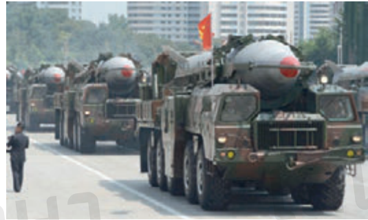
ขีปนาวุธแบบโรดอง-I (Rodong-I) ขณะเคลื่อนที่ด้วยรถยนต์ของกองทัพเกาหลีเหนือ มีระยะยิงไกล ๑,๐๐๐-๑,๕๐๐ กิโลเมตร
